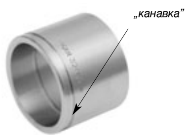
Кольцо для труб PE-Xc и PE-RT без антидиффузионной защиты имеет кольцевую проточку („канавку”) на наружной поверхности.
